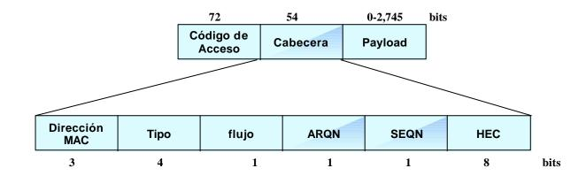
El codigo de acceso contiene secuencias de bits de sincronización e información sobre el control del enlace. La cabecera contien datos de control y el campo payload contiene los datos útiles además de un campo de CRC de 16 bits generado por el polinomio CRC-CCITT 210041 (octal).
